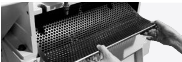
Remplacement du tamis sans difficulté
